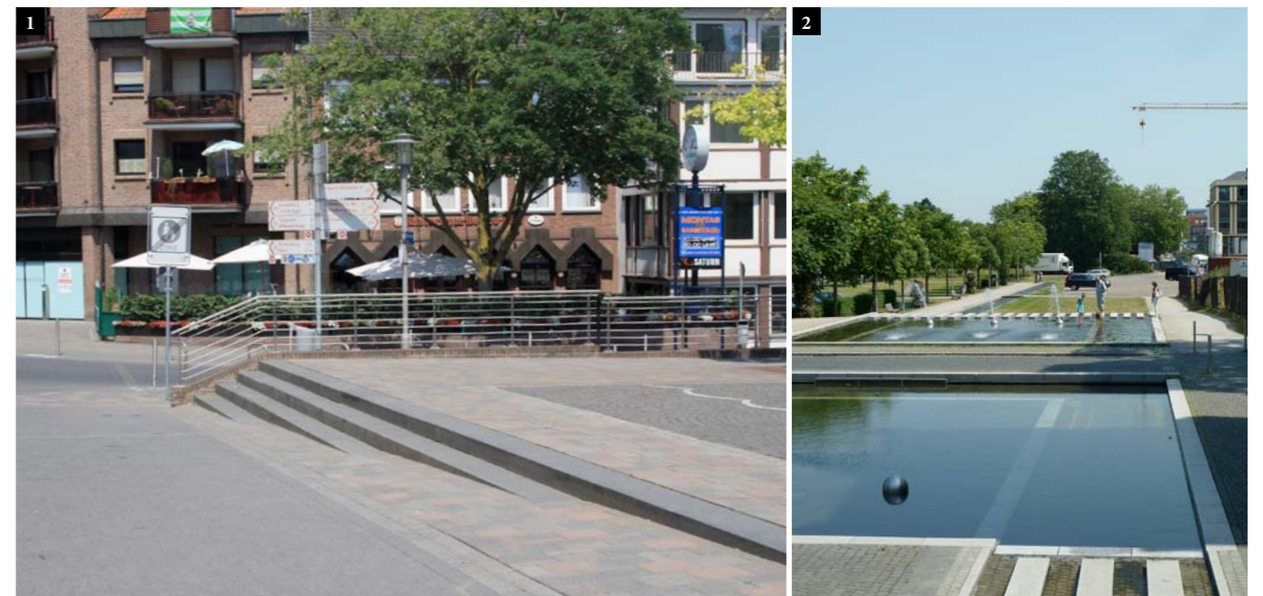
1 Bodenmuster Verschiedene Pflasterformate, -materialien und Verlegerichtungen wechseln sich ab und grenzen so einzelne Bereiche des Platzes voneinander ab 2 Wasserspiel Aufwendige Wasserkaskaden und ein Wasserlauf prägen als Gestaltungselement und verbinden mit dem angrenzenden Park 3 Terrasse Durch Gefälleausgleich entstand eine ebene Fläche, die Gastronomie und Veranstaltungen mit Bühne ermöglicht
